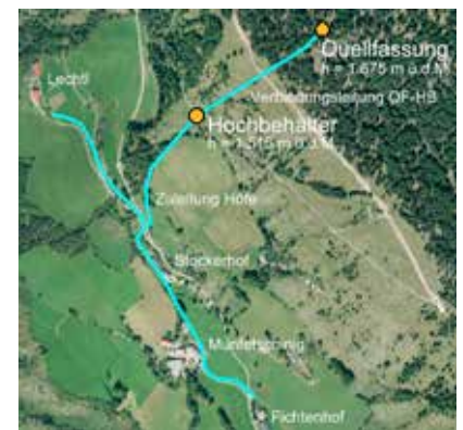
Lageplan Trinkwasserversorgung Muntetschinig
